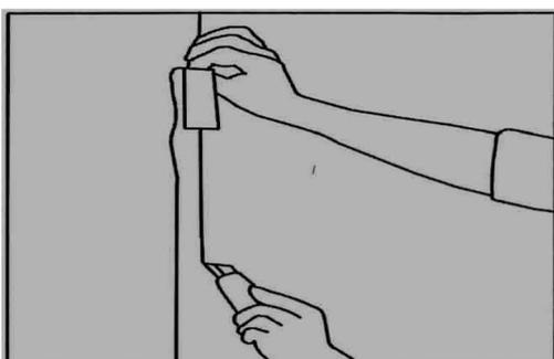
Inserte el patin del cortador de Suwide por detrás del revestimiento de forma que corte las partes superpuestas, mientras se sujeta tensionada la tira sobrante superior.
