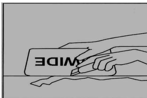
Eliminar el sobrante de revestimiento en techo y rodapié con una espátula ancha y un cutter, desplazando la espátula sin levantar el cutter.
