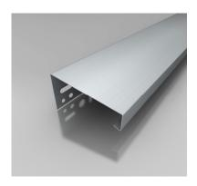
Perfil de coronación fabricado en aluminio de 1,0 mm. de espesor, se coloca en los extremos superiores de la zona a revestir con un ala de no menos de 4 cm. sobre el espesor del aislamiento, facilitando el cierre del sistema. Su borde incluye un goterón que garantiza el drenaje vertical del agua, evitando su retorno y filtración al interior.
