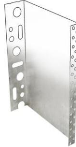
Perfil lateral fabricado en aluminio de 0,8 mm. de espesor, se coloca en los límites verticales de la zona a revestir, facilitando el cierre del sistema
