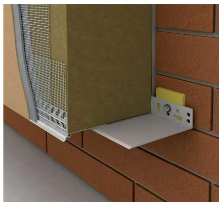
Perfil arranque PVC pared es un accesorio para utilizar con el kit de instalación de plástico en la instalación del Sistema de Aislamiento Térmico por el exterior SATE-ETICS. Para espesores de aislamiento superiores a los 30 mm. Elimina el puente térmico.
